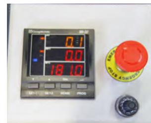
• Utilisation simple. Commande numérique pour le réglage des angles de cintrage
